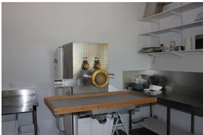
Door de kop van de persmachine aan te passen kan Olivier diverse soorten deegwaren maken
